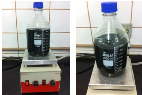
Figura 1: Reator laboratorial, em agitação sobre chapa magnética, utilizado na realização do ensaio de biodegradabilidade anaeróbia da água residuária da lavagem das baias dos cães do canil Parque Francisco de Assis em Lavras-MG.
